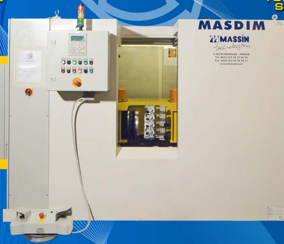
MASSIN Technologies vient de mettre au point la dessableuse MASDIM R
